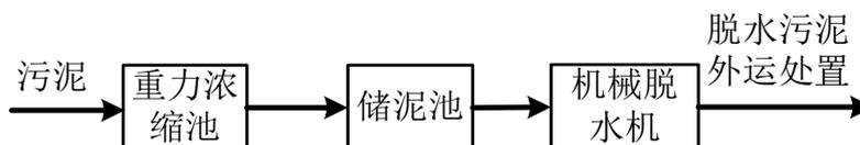
图 4.1-6 污泥重力浓缩、污泥机械脱水工艺流程图
